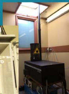
国立環境研究所 (国環研) と大学院工学研究院で 共同で設置のライダー。 地上から雲がある高度までの 大気エアロゾルの形状と量がわかる！ 観測データはオンラインで国環研のwebsiteへ！： https://goo.gl/h87WVC
