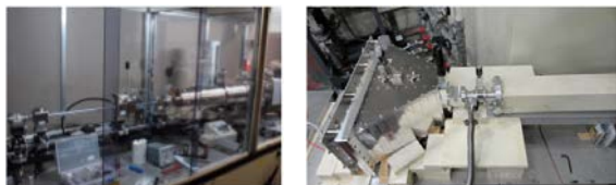
図3 世界唯一の徒歩圏で使えるインハウスX線小角散乱(左)およびインハウス中性子小角散乱(右)
